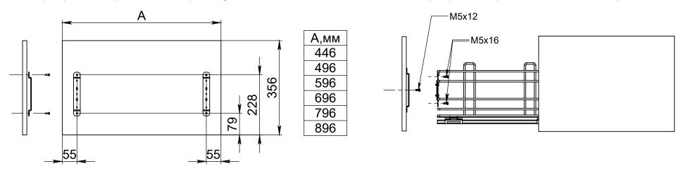
7. Отрегулировать фасад в трех направлениях. Затянуть винты.
